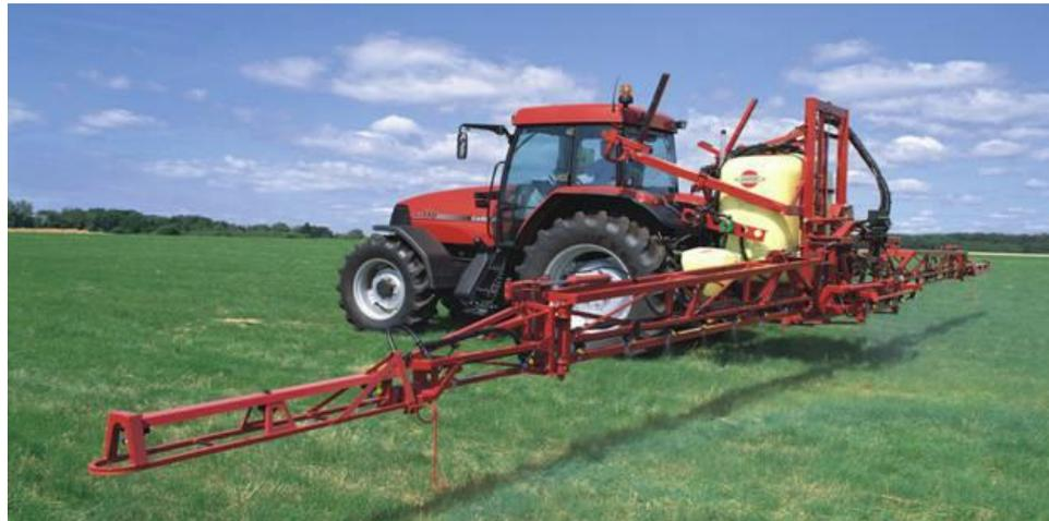
**L'altezza della barra** deve rimanere sempre costante e il suo posizionamento parallelo alla superficie del terreno durante l'esecuzione del trattamento, in maniera da garantire la corretta uniformità di distribuzione trasversale. Inoltre occorre evitare oscillazioni e sobbalzi in fase di esecuzione del trattamento.
