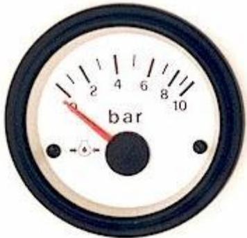
c) La **pressione** determina il grado di polverizzazione degli ugelli: dovrebbe essere per quanto possibile contenuta.
