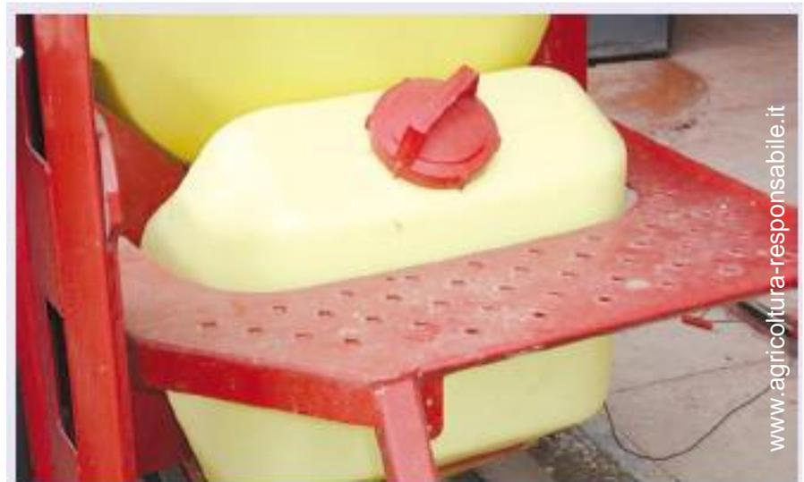
Serbatoio con acqua pulita per il lavaggio interno ed esterno dell'irroratrice.
