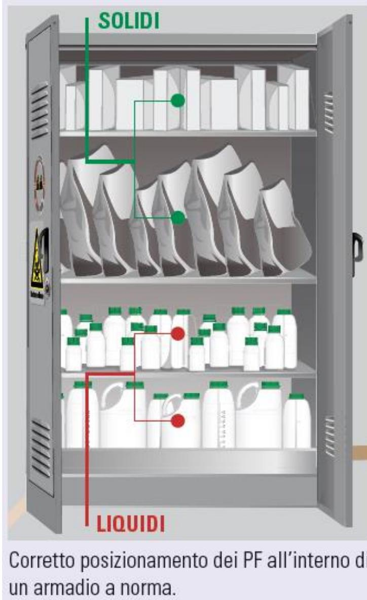
Corretto posizionamento dei PF all'interno di un armadio a norma.
