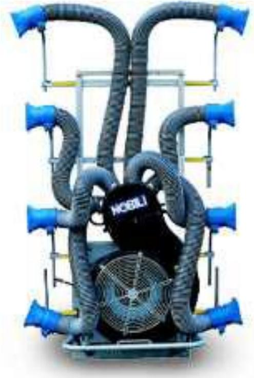
Sono irroratrici dotate di un ventilatore centrifugo da cui si dipartono tubi, rigidi o flessibili, che permettono il posizionamento degli erogatori in prossimità della vegetazione e di indirizzare il flusso d'aria in maniera mirata.
