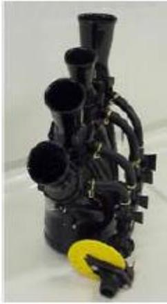
Tanto **maggiore è la velocità dell'aria**, tanto **più fini risultano essere le gocce** erogate; in genere il diametro delle gocce è pari a 50÷100  $\mu\text{m}$ .
