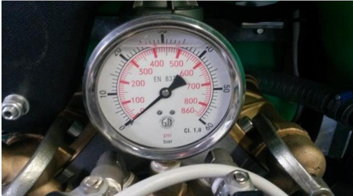
Il manometro deve essere ben leggibile dal posto di guida, quindi di diametro adeguato (almeno 63 mm se a portata di mano dell'operatore, 100 mm se montato sulla macchina); la scala di lettura deve avere una risoluzione di 0,2 bar per impieghi fino a 5 bar, e di un bar per l'uso fino a 15 bar.
