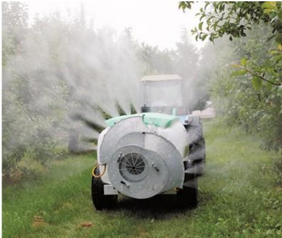
Sono macchine generalmente **caratterizzate** dalla presenza di un **ventilatore** e da **semibarre semicircolari** o verticali, presenti su entrambi i lati della macchina, dotate di ugelli adatti a distribuire i PF sulle colture arboree (frutteti, agrumeti, oliveti, vigneti): le gocce sono indirizzate verso la chioma della vegetazione a partire da un piano verticale.
