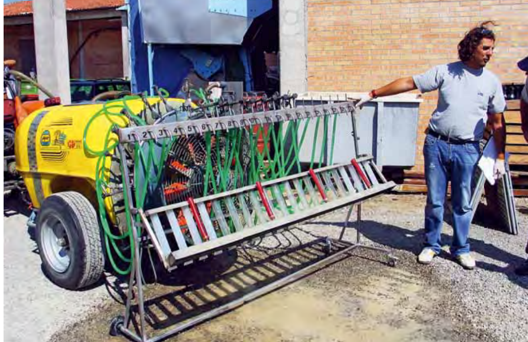
Foto 10 Determinazione della portata degli ugelli in fase di controllo funzionale
