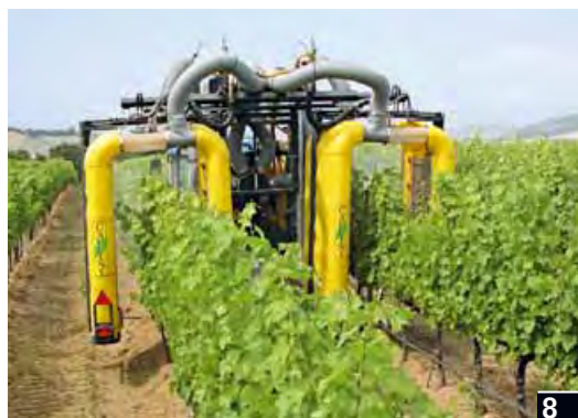
Foto 8-9 Irroratrice a tunnel (8) e a carica elettrostatica (9)
