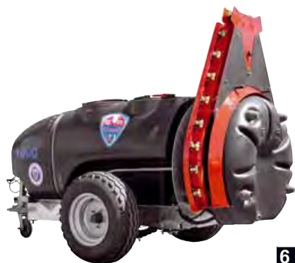
Foto 6-7 Esempi di sistemi a getto mirato a torretta (6) e con testata multifila scavallatrice (7)
